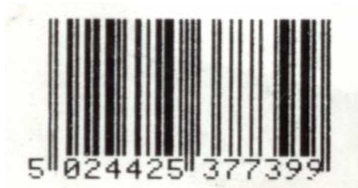
Abbildung 5.5.3.3.12 – 1 Symbol mit Problemen bei der Kantenvermessung
