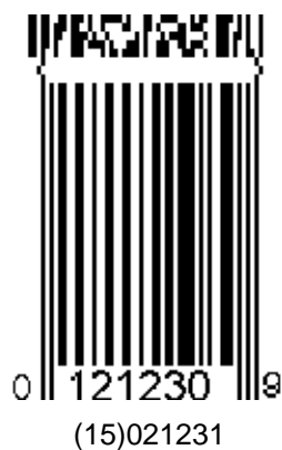
Abbildung 5.8.8 – 4 UPC-E Symbol mit einer 2-spaltigen CC-A Komponente
