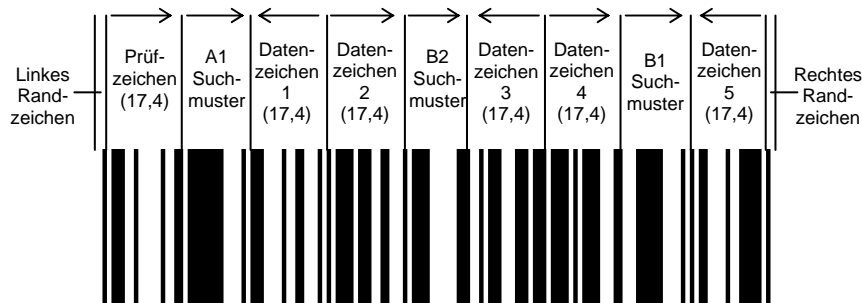
Abbildung 5.6.1.4 – 1 GS1 DataBar Expanded Struktur
