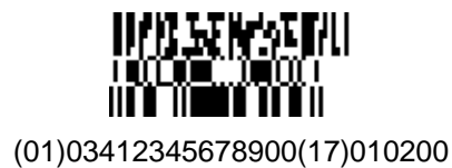
Abbildung 5.8.8 – 6 GS1 DataBar Stacked Symbol mit einer 2-spaltigen CC-A Komponente
