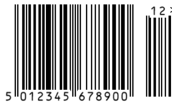
Abbildung 5.2.2.3.5.1 – 2 EAN-13 Strichcode mit einem zweistelligen Zusatzsymbol
