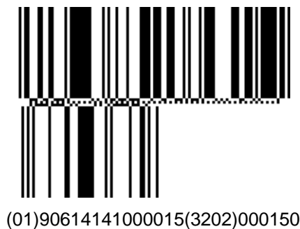
Abbildung A1.3 - 1 Beispiel eines GS1 DataBar Expanded Stacked Symbols mit verketteten Daten
