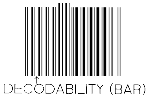
Abbildung 5.5.3.3.12 – 3 Symbol zur Kalibrierung mit einer bewusst niedrigen Klassifizierung der Dekodierung
