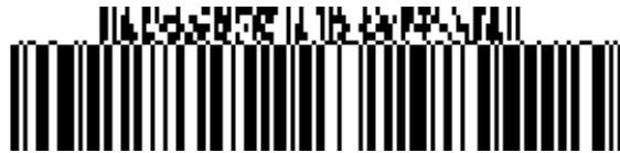
Abbildung 5.8.8 – 9 GS1-128 Symbol mit einer 4 spaltigen CC-A Komponente
