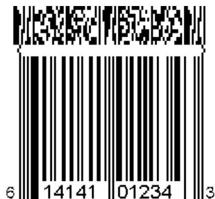
Abbildung 5.8.8 – 2 UPC-A Symbol mit einer 4-spaltigen CC-B Komponente
