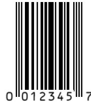
Abbildung 5.2.2.3.4 – 1 UPC-E Strichcodesymbol (Verschlüsselung von "001234000057" durch Nullunterdrückung)
