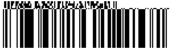
Abbildung 5.8.8 – 8 GS1 DataBar Expanded Symbol mit einer 4-spaltigen CC-A Komponente
