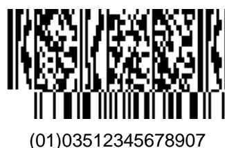
Abbildung 5.8.8 – 7 GS1 DataBar Limited Symbol mit einer 3-spaltigen CC-B Komponente
