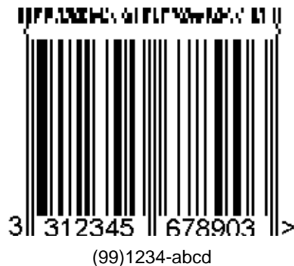
Abbildung 5.8.8 – 1 EAN-13 Symbol mit einer 4-spaltigen CC-A Komponente
