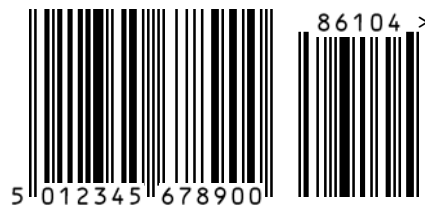
Abbildung 5.2.2.3.5.2 – 2 EAN-13 Strichcode mit einem fünfstelligen Zusatzsymbol
