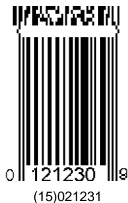
Abbildung A1.3 - 2 Beispiel eines Composite Symbols (GTIN im UPC-E, Mindesthaltbarkeitsdatum in der Composite Component verschlüsselt)
