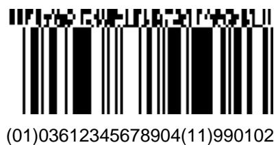
Abbildung 5.8.8 – 5 GS1 DataBar Omnidirectional Symbol mit einer 4-spaltigen CC-A Komponente
