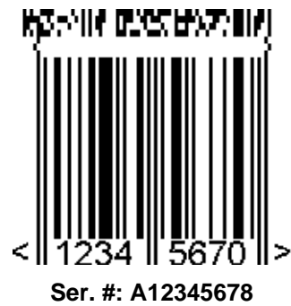
Abbildung 5.8.8 – 3 EAN-8 Symbol mit einer 3-spaltigen CC-A Komponente
